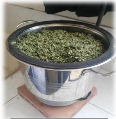
El orégano es colocado en un destilador de arrastre por vapor de agua por 1 hora
