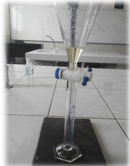
Una hora después del del proceso de destilado por vapor obtención de aceite esencial concentración al 100 % (puro)
