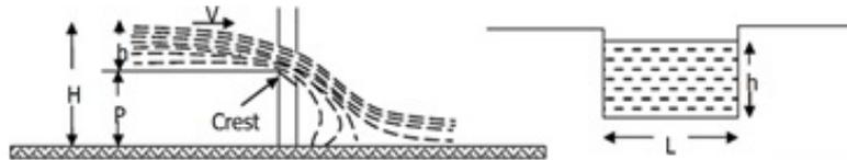
Calculando altura (h) de agua sobre vertedero para caudal de ingreso ( $Q=0.463 \text{ l/s}$ )
