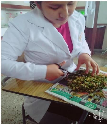
Primero se triturar  manualmente y luego con ayuda de un Molinillo de Caf  marca BOSCH MKM6003 180 W. Luego el material vegetal ya en polvo bajo condiciones de calidad de la muestra seg n las normas establecidas por farmacopeas
