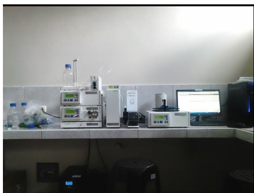
Cromatógrafo Iónico CECIL Adept / Q-Adept, Supresor Químico Autoregenerativo CE 4715, Detector de conductividad CE 4710, Bomba CE 4100: 1.5 ml x min, Canal A, AUTOSAMPLER CE 4800-50 y Columna Allsep anión, 150 x 4,6 mm, 7 \mu m.
