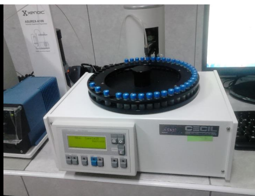
Cromatógrafo Iónico CECIL Adept / Q-Adept, Supresor Químico Autoregenerativo CE 4715, Detector de conductividad CE 4710, Bomba CE 4100: 1.5 ml x min, Canal A, AUTOSAMPLER CE 4800-50 y Columna Allsep anión, 150 x 4,6 mm, 7 \mu m.
