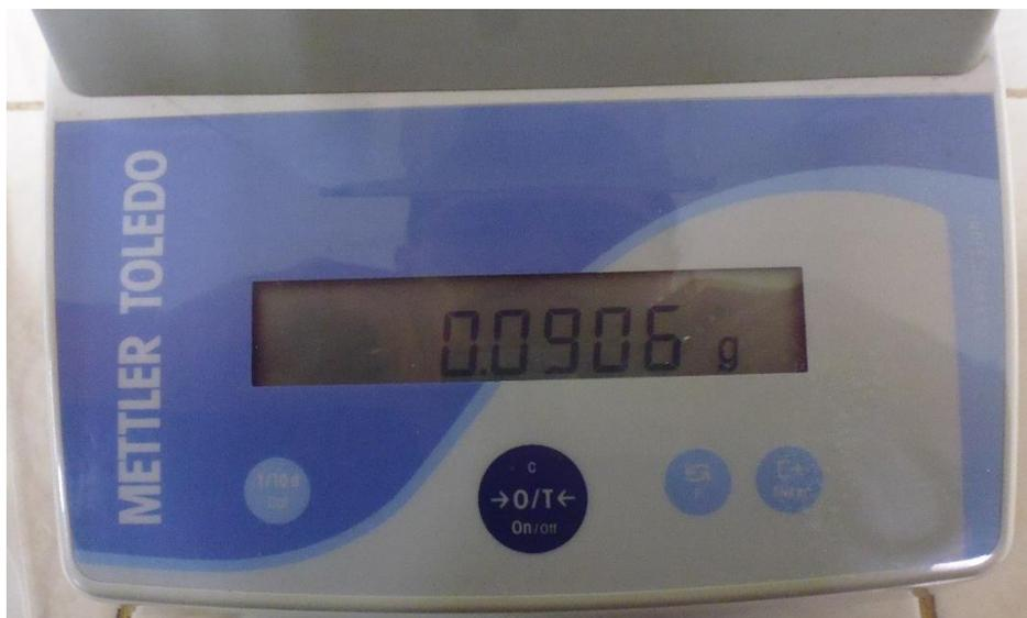
Marcador final de un arco despues de el experimento en la balanza analítica marca METTLER TOLEDO (AL54)
