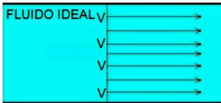
Figura N°03: Velocidad lineal en fluidos ideales.
