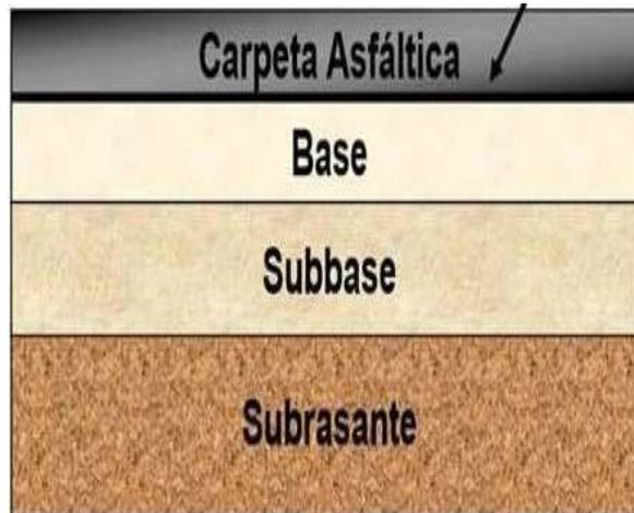
*Figura 1: Estructura del pavimento flexible*
