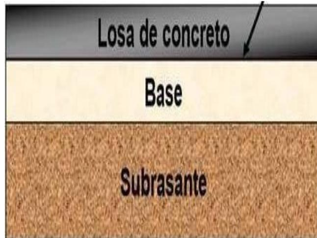
*Figura 2: Estructura del pavimento Rígido.*
