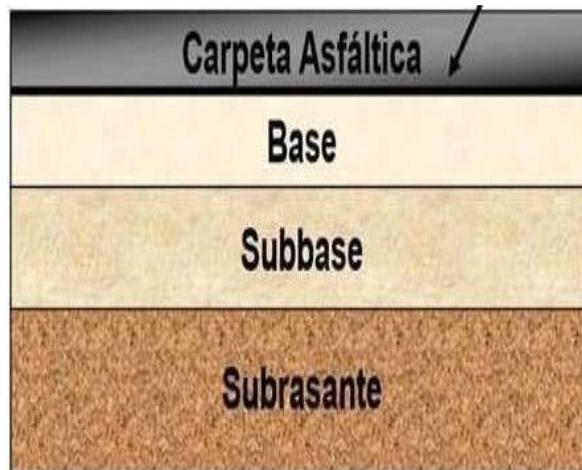
*Figura 1: Estructura del pavimento flexible*
