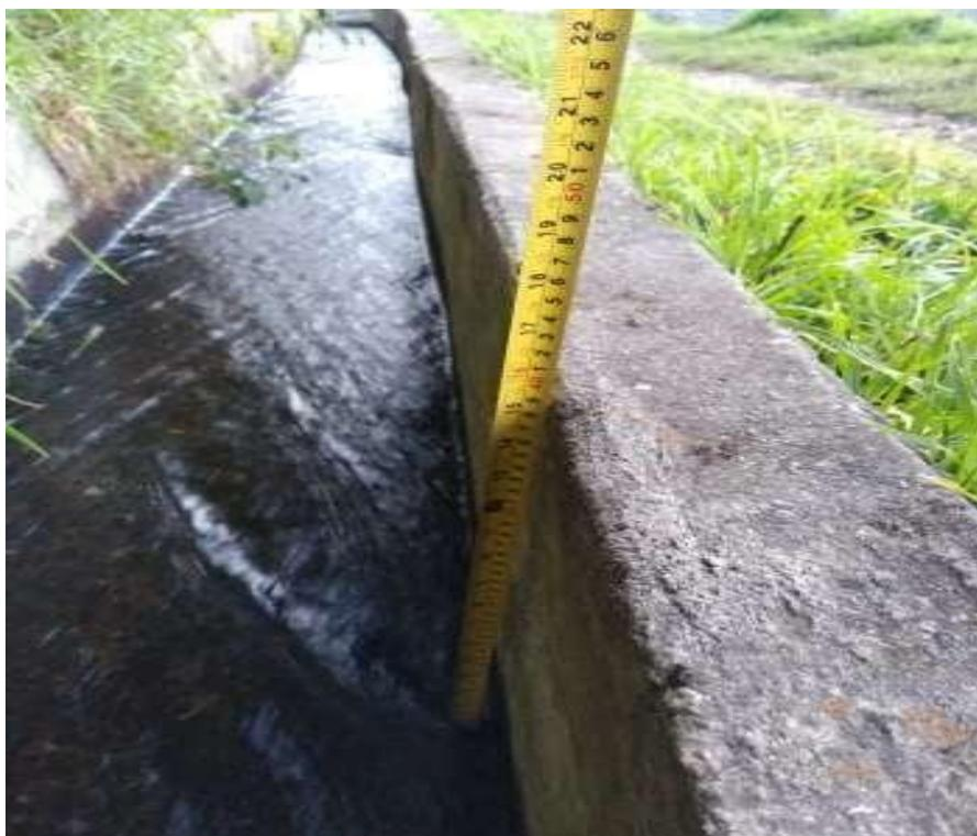
**Fotografía N°6** se observa la medición de la altura del canal
