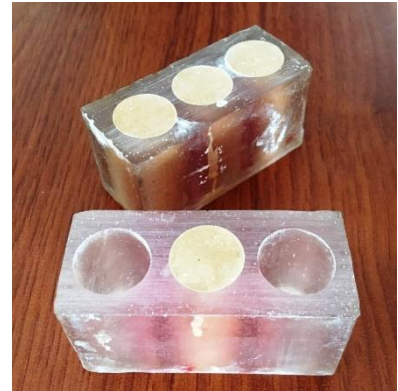
Imagen 2: Porta muestras lista para su medición
