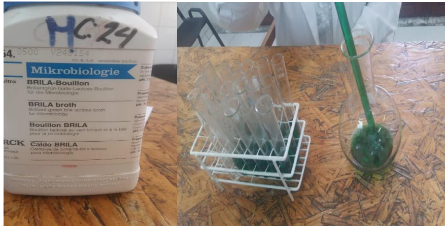
FIGURA 9. Se procedió a realizar la preparación del medio Caldo brilla y bilis al 2%, 40g en 1000 mililitros de agua destilada (concentración simple) y 40g en 500 mililitros de agua (doble concentración), este procedimiento fue realizado por el técnico encargado del laboratorio.
