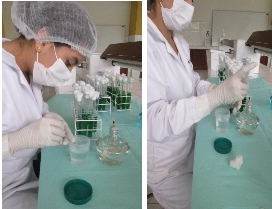
FIGURA 16,17. Se transfirió con ayuda de una pipeta parte de la muestra de agua hacia cada uno de los tubos, teniendo siempre cerca un mechero de alcohol para esterilizar el ambiente y no haya contaminación.
