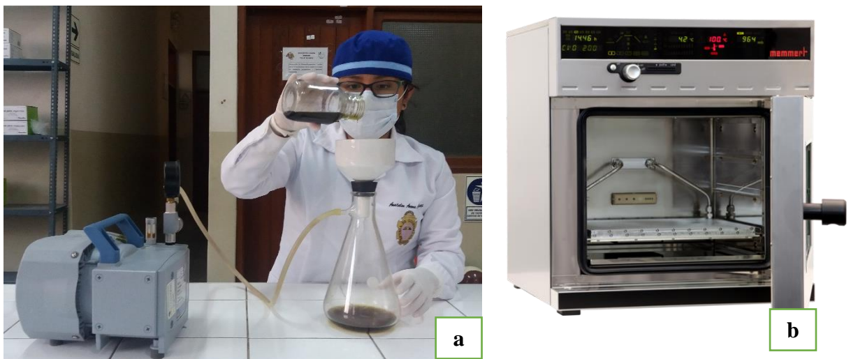
Figura 5. Filtración (a) y sequedad en cámara de secado al vacío (b).
