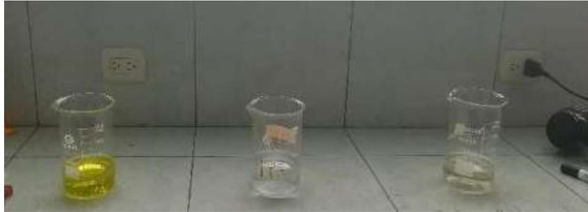
Bloques de resina 3M™ Filtek™<sup>®</sup>Z350 XT Y Tetric N-ceram<sup>®</sup> sumergidos en Inka Cola.
