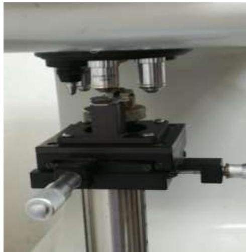
Medición de los bloques de resinas 3M™ Filtek™<sup>®</sup>Z350 XT y Tetric N-ceram<sup>®</sup> en el Microdurómetro de Vickers.
