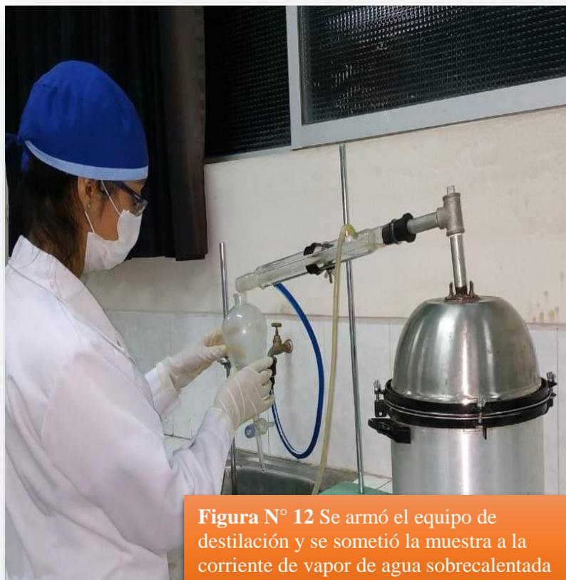
**Figura N° 12** Se armó el equipo de destilación y se sometió la muestra a la corriente de vapor de agua sobrecalentada
