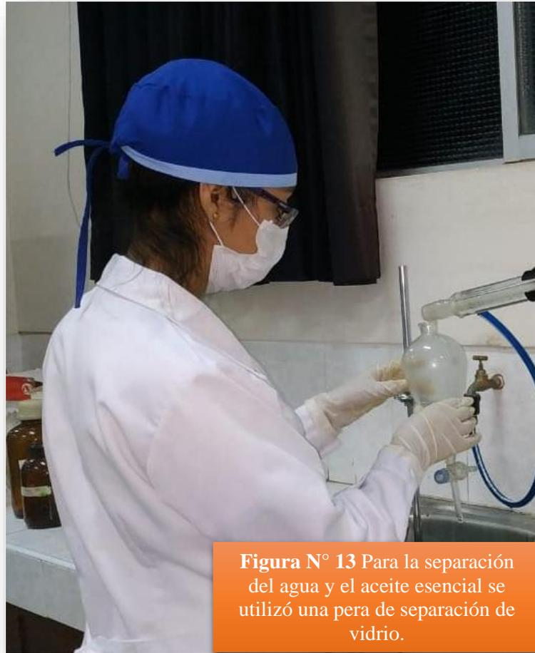
**Figura N° 13** Para la separación del agua y el aceite esencial se utilizó una pera de separación de vidrio.
