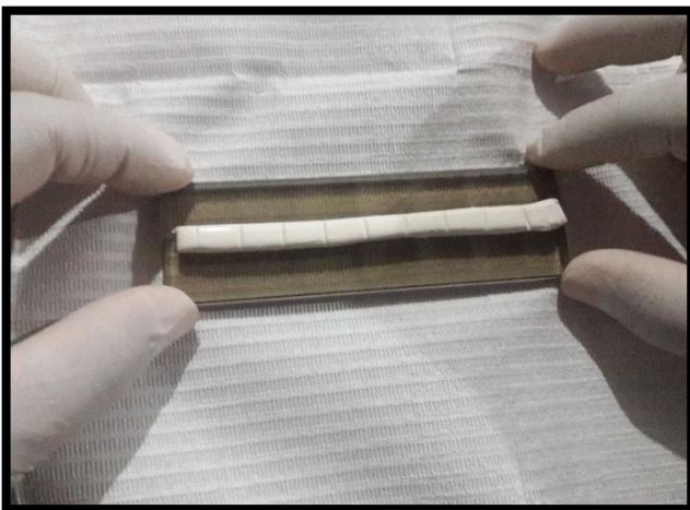
Fuente Propia: Preparación de muestras (Colocación de los dientes de acrílico en las platinas fijados con Masa autoadhesiva)
