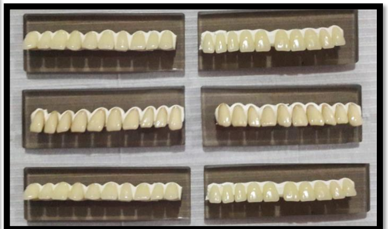
Fuente Propia: Preparación de muestras (Colocación de los dientes de acrílico en las platinas fijados con Masa autoadhesiva)
