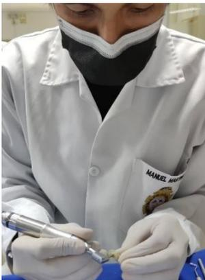
Figura 6. Pulido de los discos de resina con discos Sof-Lex de grano fino.
