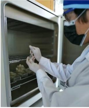
Figura 8. Esterilización de los discos de resina compuesta por un tiempo determinado de 1 hora a 140 °C.
