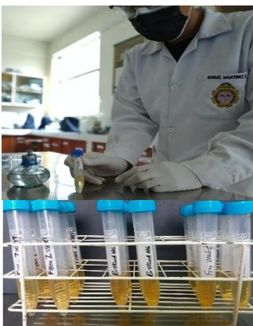
Figura 14. Discos de resina Filtek™ Z350XT 3M, Brilliant™ NG COLTENE y Forma™ ULTRADENT en 5 mL de tripsina al 0.25% en EDTA.
