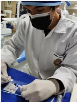
Figura 2. Elaboración de los discos de resina sobre una matriz predefinida. (FILTEK™ Z350XT 3M).
