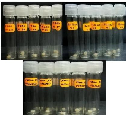
Figura 7. Se desinfectó los discos de resina compuesta con etanol al 70% durante 24 horas, luego fueron lavados con agua destilada y se guardaron en tubos de ensayo de base plana estériles.
