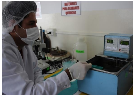
Figura 7. Ambos Grupos De Muestras Fueron Sometidos A 100 Ciclos De Termociclado
