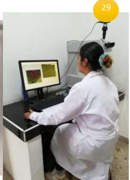
FIGURA 27-28- Para determinar la microdureza superficial se medirán y promediaran las diagonales de cada indentación, haciendo uso de del Software Confident Hardness Testing Program. FIGURA 29- Microdurometro Vickers con la probeta.
