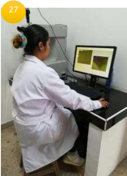
FIGURA 27-28- Para determinar la microdureza superficial se medirán y promediaran las diagonales de cada indentación, haciendo uso de del Software Confident Hardness Testing Program. FIGURA 29- Microdurometro Vickers con la probeta.
