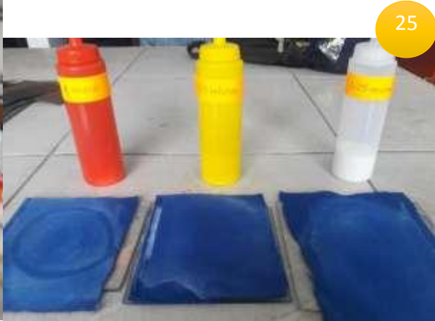
FIGURA 24-25- Devastar con lija N°100, 1500, 2000, 2500. Pulir en paño con alúmina oxido de aluminio más agua destilada. (1micra, 0.3 micras, 0.05 micras).
