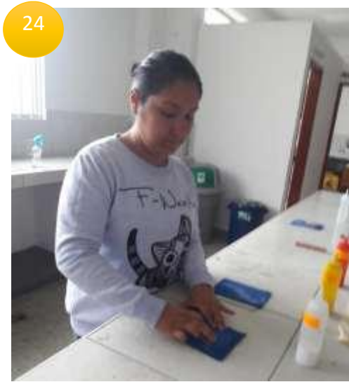
FIGURA 24-25- Devastar con lija N°100, 1500, 2000, 2500. Pulir en paño con alúmina oxido de aluminio más agua destilada. (1micra, 0.3 micras, 0.05 micras).
