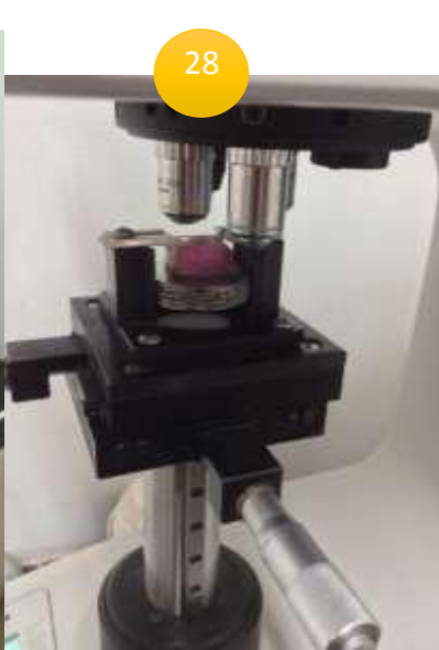
FIGURA 27-28- Para determinar la microdureza superficial se medirán y promediaran las diagonales de cada indentación, haciendo uso de del Software Confident Hardness Testing Program. FIGURA 29- Microdurometro Vickers con la probeta.
