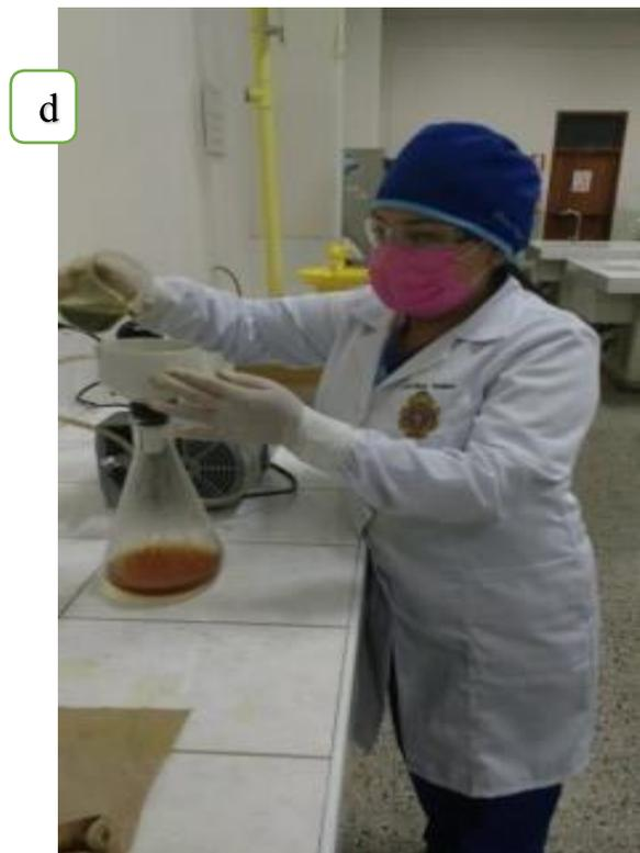
Figura 3. Añadir etanol-agua (a) hasta cubrir la muestra de polvo de hojas del *Cymbopogon citratus* (*Hierva Luisa*) y mezclar (b). Llevar a la estufa (c) colocamos el líquido en un vaso de precipitado, (d) filtración.
