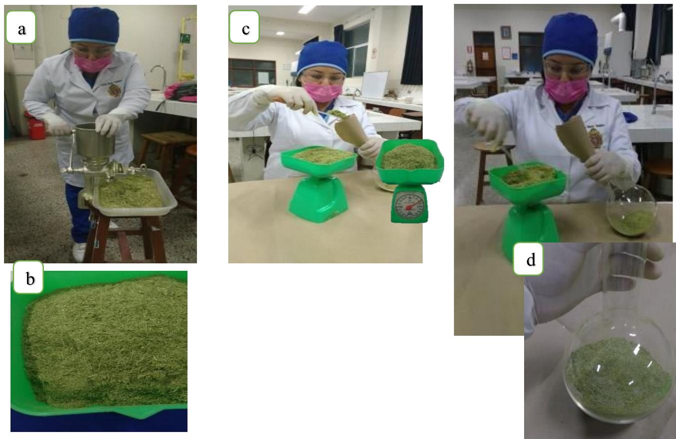
Figura 2. Pulverización (a), tamizaje (b), pesar (c) y vacear (d) el polvo de hojas del *Cymbopogon citratus*. A un balón de destilado.
