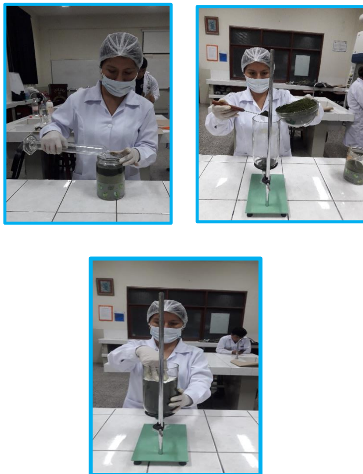
Fig 6: Preparación del sistema de percolación
