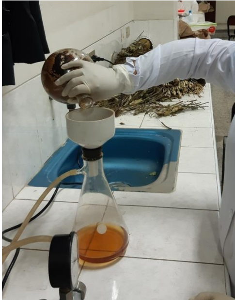
Figura 08. Se filtraron cada macerado, al vacío con papel de filtro Whatman# 1 y luego con filtros Millex (Millipore) de 0,22 mm para esterilizar el extracto.
