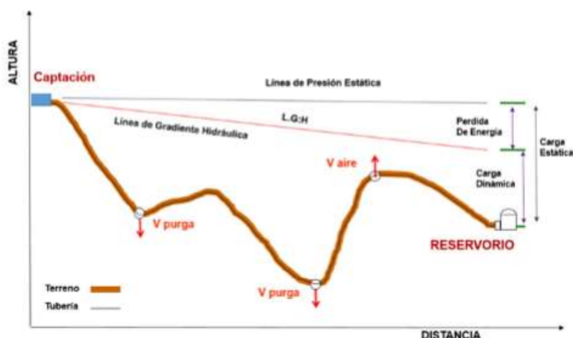
Ilustración N° 03.31. Línea de Conducción
