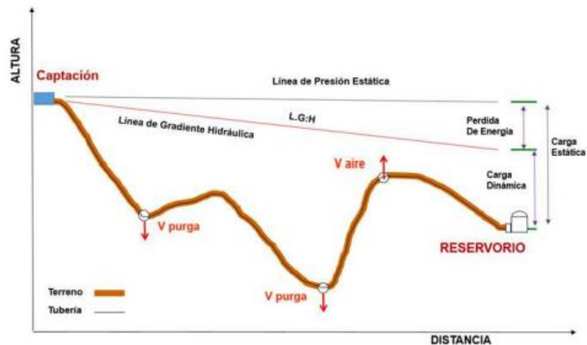
Figura 7. Línea de conducción Fuente: RM-192-2018-VIVIENDA
