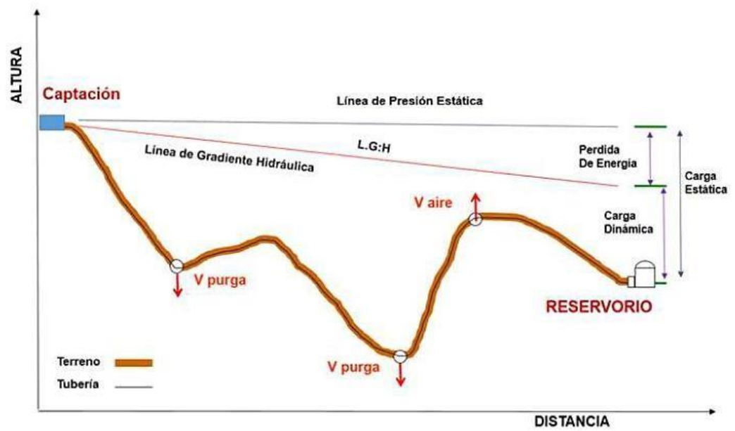
Ilustración N° 03.31. Línea de Conducción
