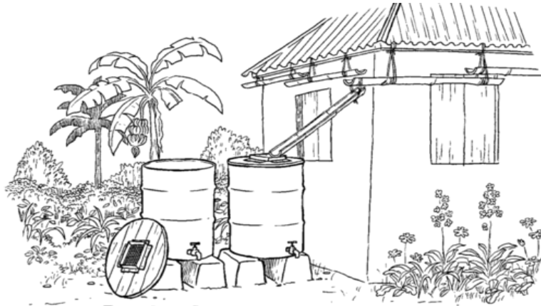
Fig.; 2 Captación de agua de lluvia
