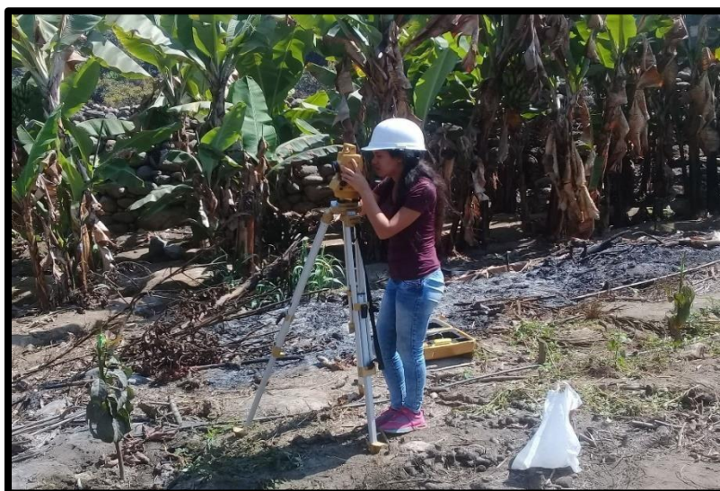
Imagen N ra 07: Levantamiento topográfico de la línea de conducción del caserío de Larea Baja, Distrito de Moro, Provincia de Santa, región Áncash.
