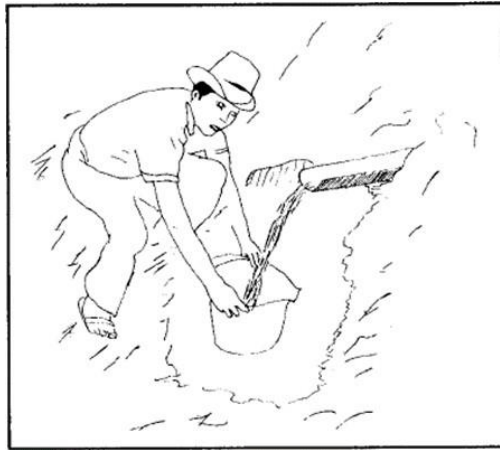
Figura 5: Aforo de agua por método volumétrico.
