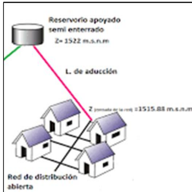
Figura 13: Línea de aducción
