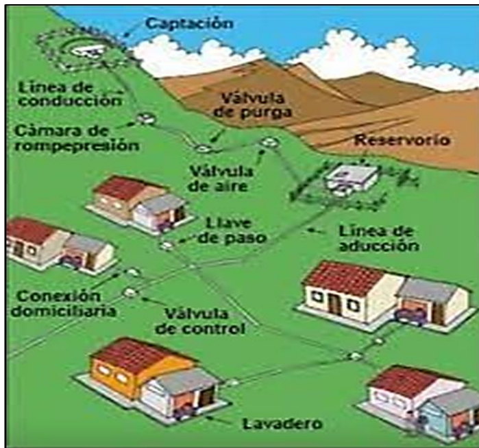
Figura 1: Sistema de abastecimiento de agua potable
