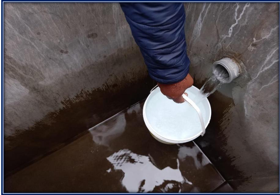
**Imagen 24:** Realizando la medición del caudal
