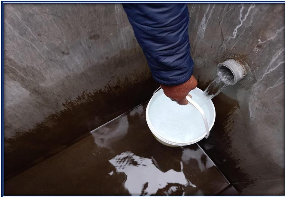
**Imagen 06:** Medición de agua por método de volumétrico.
