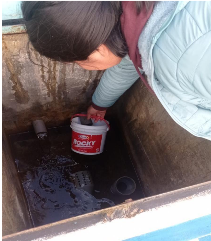
FOTO N°9: REALIZANDO EL AFORAMIENTO DE LA LLORONA DE LA SEGUNDA CAPTACION
