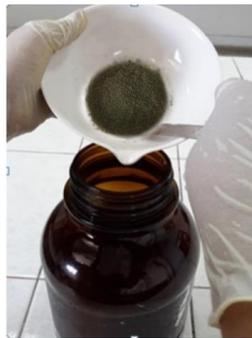
**Fotografía 5.** Colocando 500g de polvo de propóleo en un frasco + 2000 mL de etanol 96°, llevando a extraer con agitación x 48 h.
