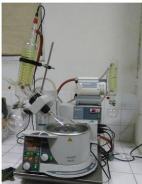
**Fotografía 8.** Evaporación del solvente etanol del extracto etanólico de propóleo en el rotaevaporador.
