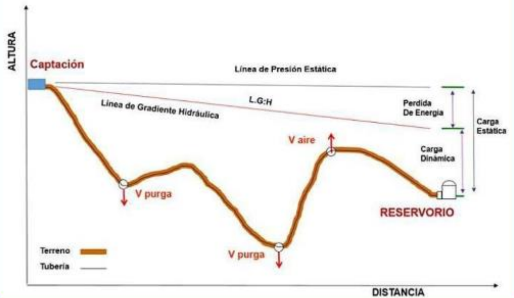
Ilustración N° 03.31. Línea de Conducción
