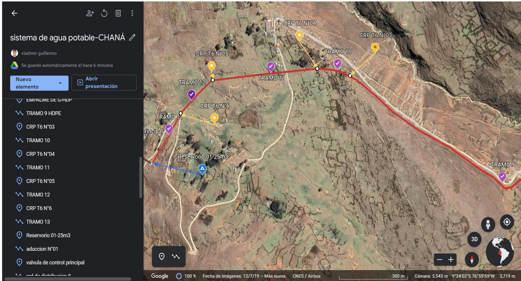
Figura 18: Tramo 09 al tramo 13 de la línea de conducción
