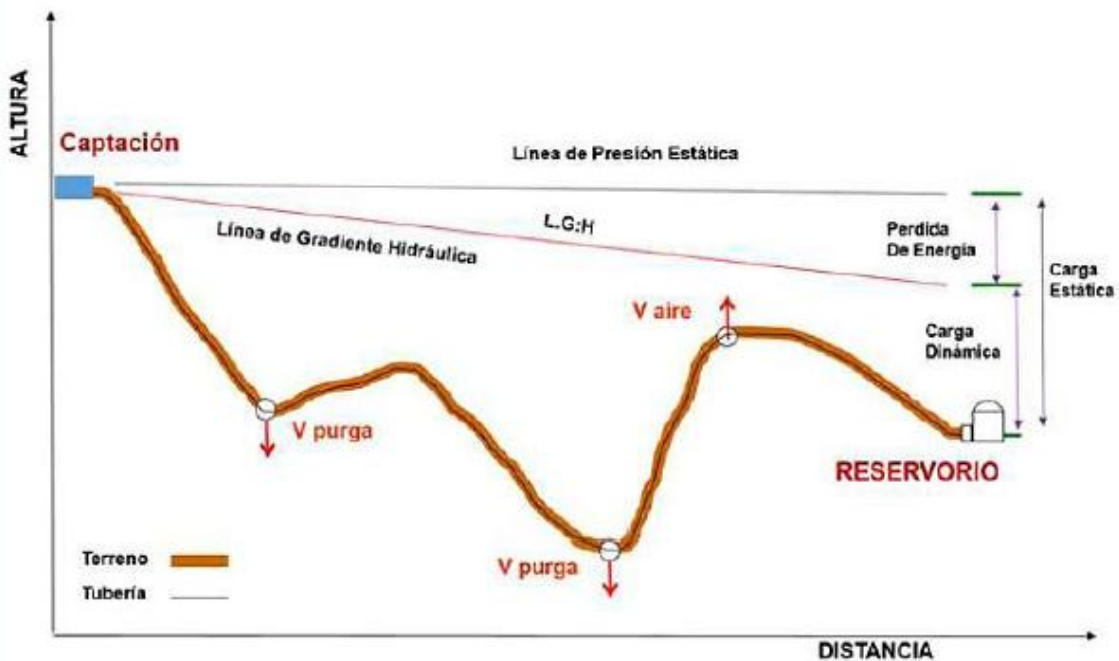
Ilustración N° 03.31. Línea de Conducción
