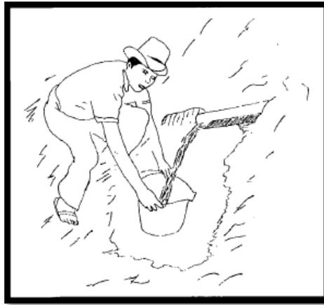
Figura 2: Método volumétrico
