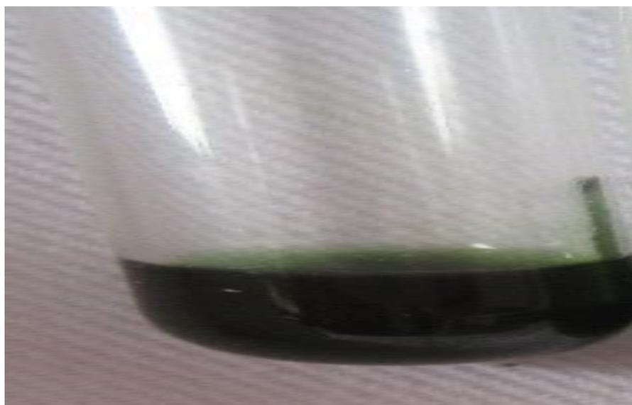
Anexo 15: Tubo del ensayo con extracto etanólico, prueba de Borntrager que identifica Quinonas, en el cual se observa un resultado positivo.
